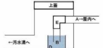
図の網掛け部分には常に水が溜まっており、屋内から水が排出されると、カップから水があふれて、汚水枦から排水溝へ流れる構造になっています。この構造は、洗面台の下の排水パイプがS字型に曲がっていたり、トイレにはいつも水が溜まっているのと同じことで、排水溝からの悪臭や、鼠、虫などをこの溜まった水で遮断するもので、トラップと呼ばれています。
