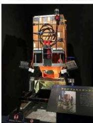
写真:「深海2017」にて展示中のフルデプスミニランダー。最上部に浮力材が載り、その下にはカメラや電子回路を組み込んだガラス球が配置される。投入時には底部に鉄製の錘が取り付けられる。着底後、タイマーが一定の周期でカメラとライトを制御して撮影が行われる。回収時は錘を切り離し、海面に浮上させる。8000mの降下と上昇にかかる時間は、それぞれ3時間以上である。小栗
